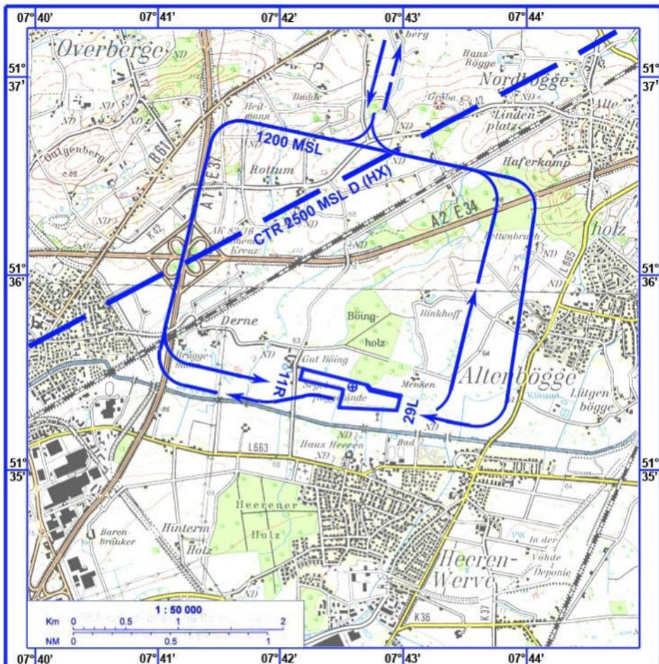
Der Segelflugplatz Kamen-Heeren wird grundsätzlich von Norden angeflogen. In die CTR darf nur nach Kontaktaufnahme mit Kamen Info und/oder Dortmund Turm eingeflogen werden. Motorgetriebene LFZ nutzen die Start-/Landebahn 11R/29L.
